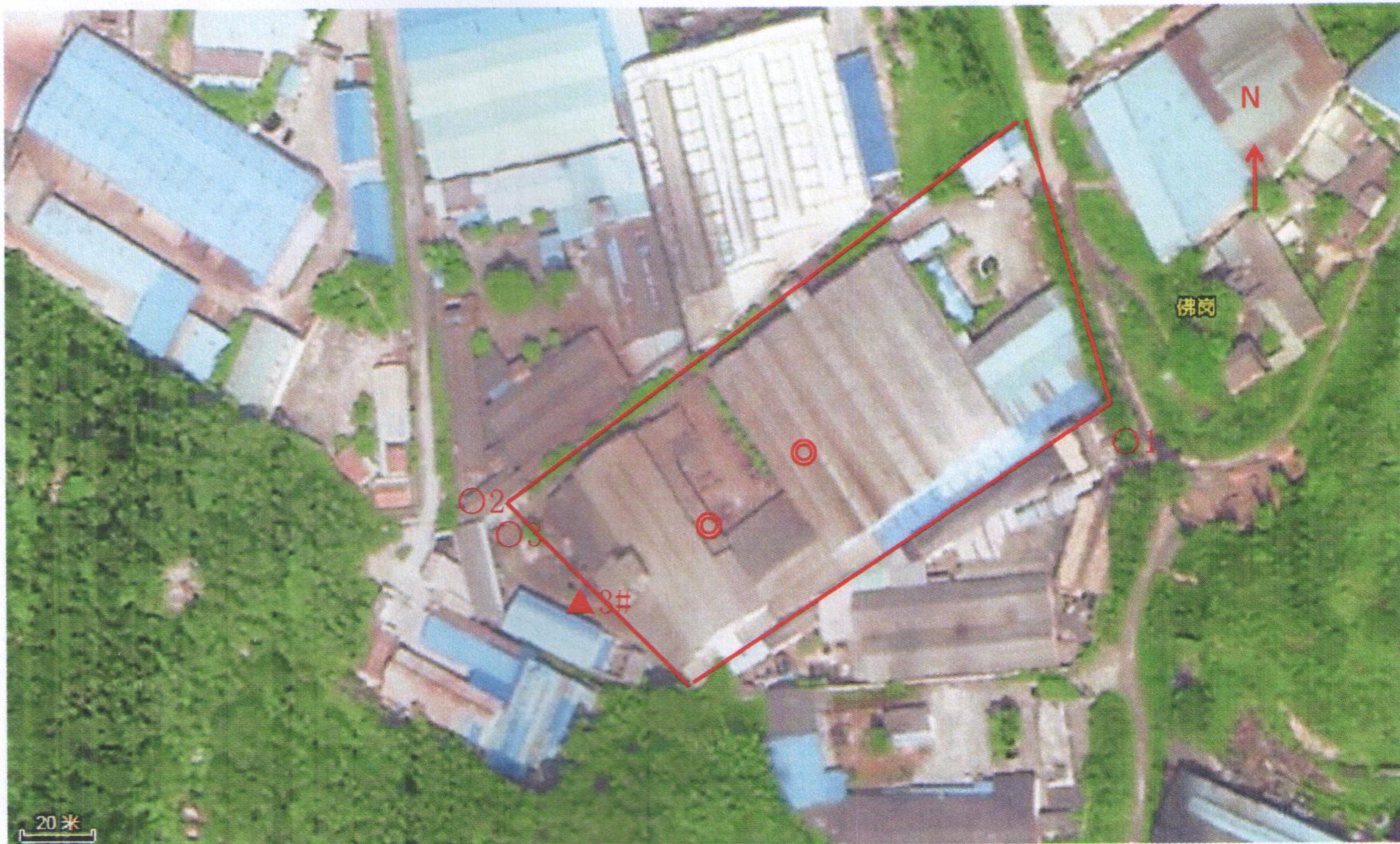
图1 监测布点示意图 (◎有组织废气监测点○无组织废气监测点)
